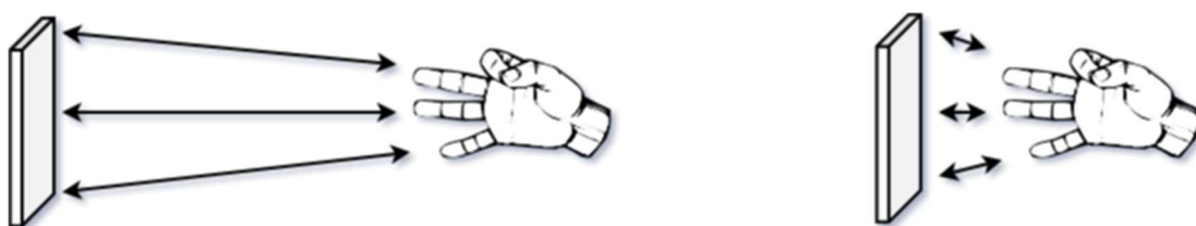
Réponse capacitive de l'antenne à plaque en champ lointain et en champ proche.
